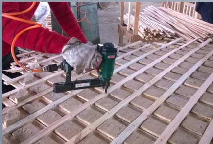
Trillage armado y corcheteado de enrejado
